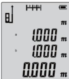
Ändern Sie den Wert der Strecke (a) mit den „-“ und „+“-Tasten und bestätigen Sie diesen Wert mit der „EIN-/MEAS“-Taste (1). Anschließend blinkt der Wert für die zweite Strecke (b), welche Sie auch mit den „-“ und „+“-Tasten verändern. Bestätigen Sie erneut mit „EIN-/MEAS“-Taste (1).
