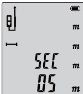
Nutzen Sie nun die „-“ und „+“-Tasten, um die Sekunden bis zur zeitverzögerten Messung festzulegen und bestätigen Sie mit der “EIN-/MEAS”-Taste (1). Nun Beginnt ein Countdown, bis null, bei welchem die Messung ausgelöst wird
